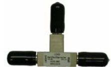
Étalonnage Rapport d'ondes stationnaires (ROS) sur court-circuit - circuit ouvert - charge (TNC) 38245
